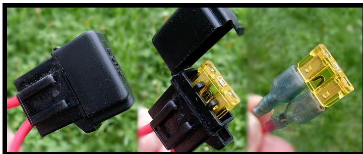
Vzhled držáku na autopojistku a vpravo jeho nouzová náhrada - konektory „faston“.
